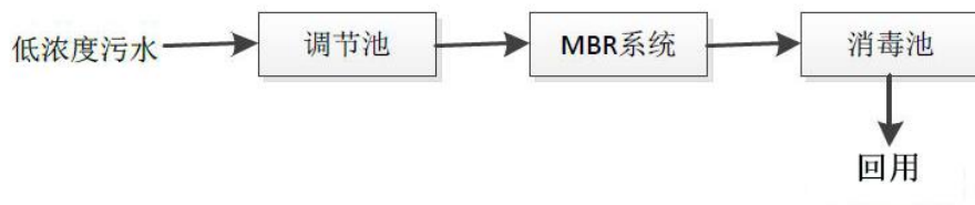
图 2.3-9 厂区低浓度污水处理站工艺流程
